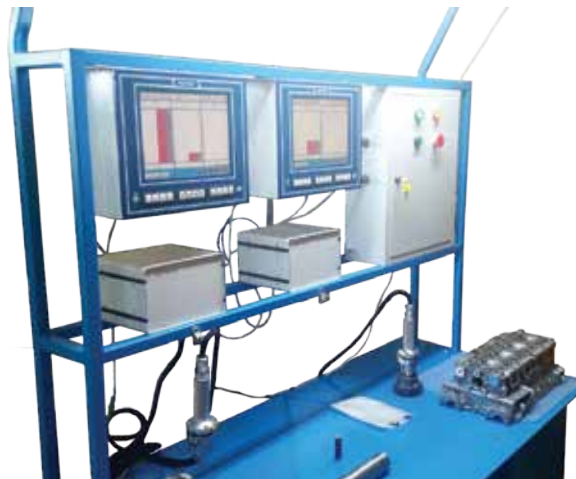
Стенд КИ 1641 для контроля геометрических параметров головки цилиндров (2018 г., объем договора 2 млн руб.)
