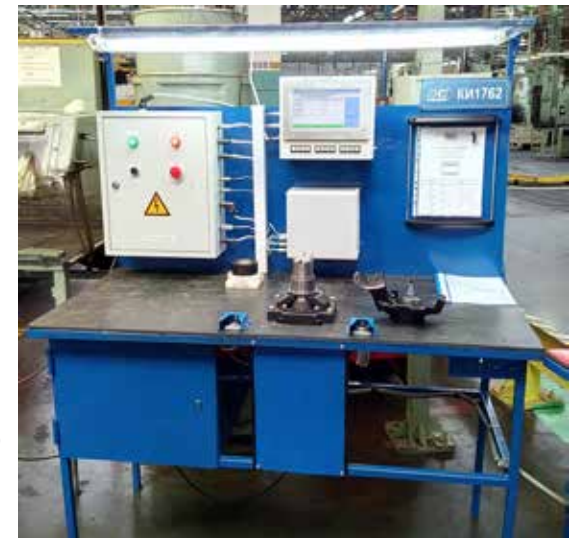
Контрольный стенд КИ1762 для контроля геометрических параметров кулака поворотного (2018 г., объем договора 2 млн руб.)
