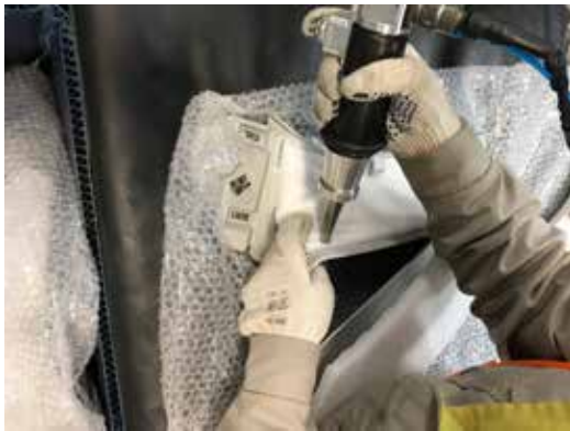
Установка для ультразвуковой сварки автокомпонентов из полимерных материалов (2018 г., объем договора 2 млн руб.)
